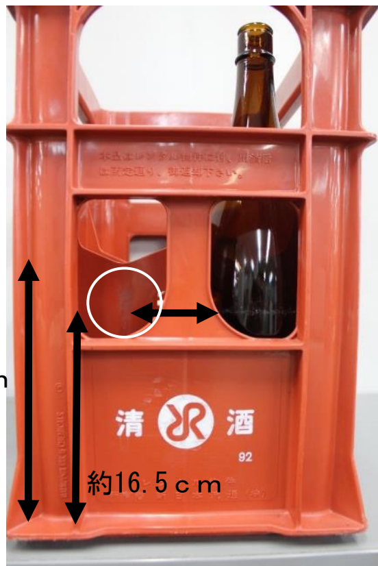
6P函仕切りとの接触(輸送中)
